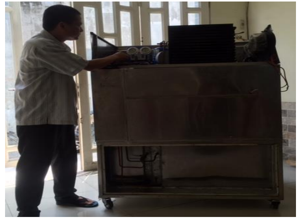
Hình 12.3. Vận hành thiết bị sấy
