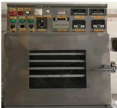
Hình 2.2. Thiết bị thí nghiệm xác định hệ số dẫn ẩm và khuếch tán ẩm phân hoa
